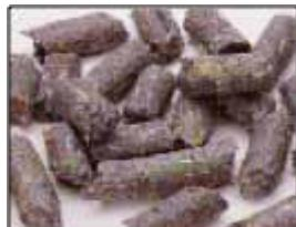
作った RDF は、三重ごみ 固形燃料発電所で、電力として再利用しています。
