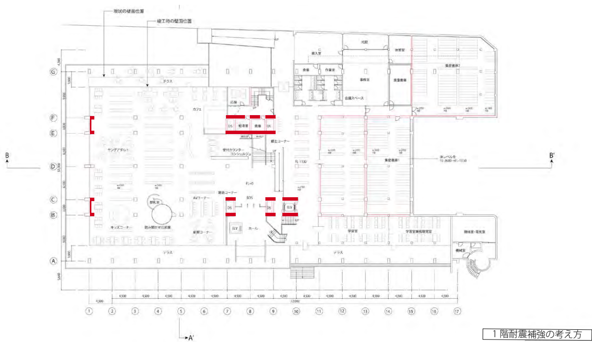
1 階耐震補強の考え方
