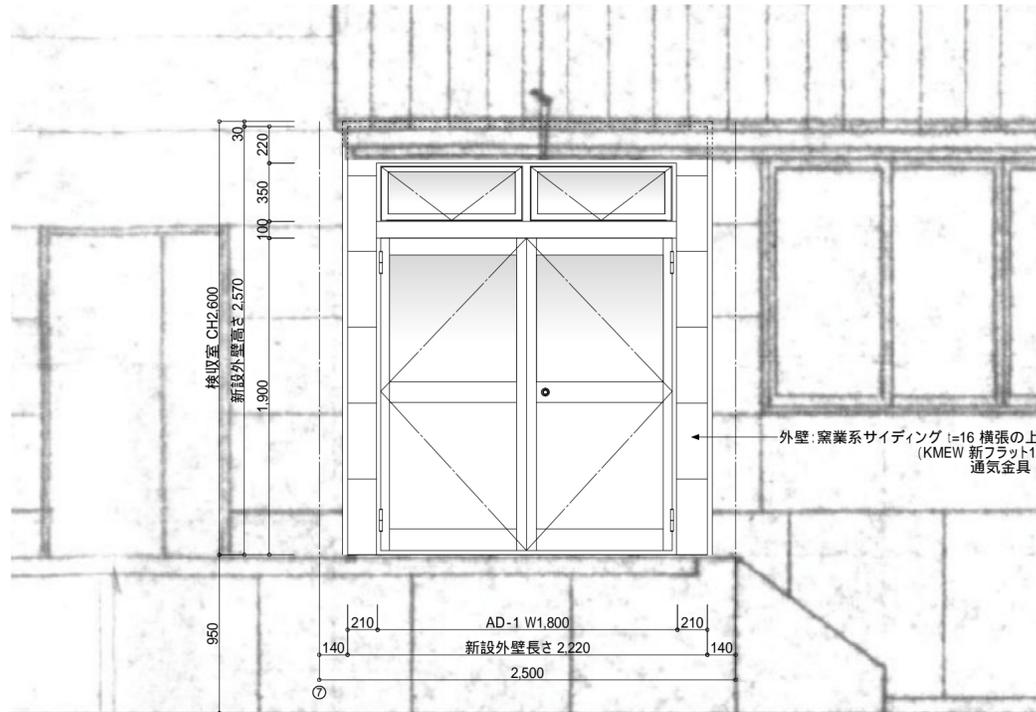
外壁:窯業系サイディング t=16 横張の上、外装薄塗材E吹付
