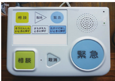
緊急通報装置本体
