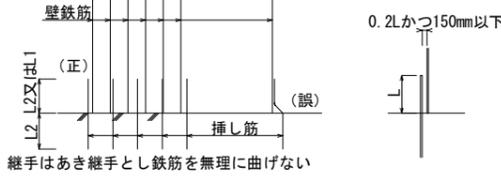
図14-1 壁挿し筋図
