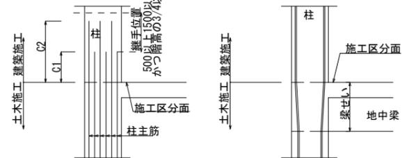
図14-2 柱主筋の結合位置
