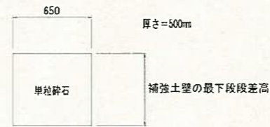
縦暗渠断面図 S=1:20
