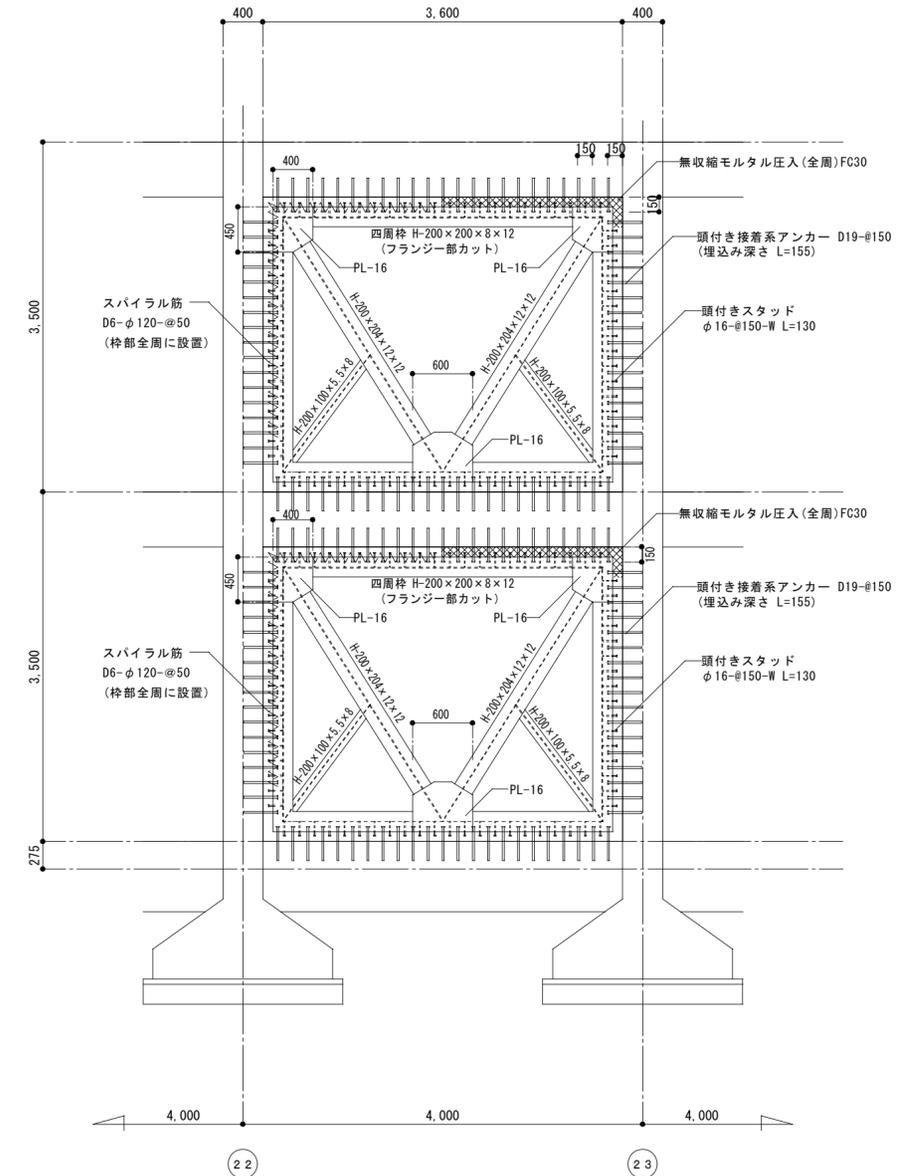
鉄骨ブレース断面詳細図 S=1:50
