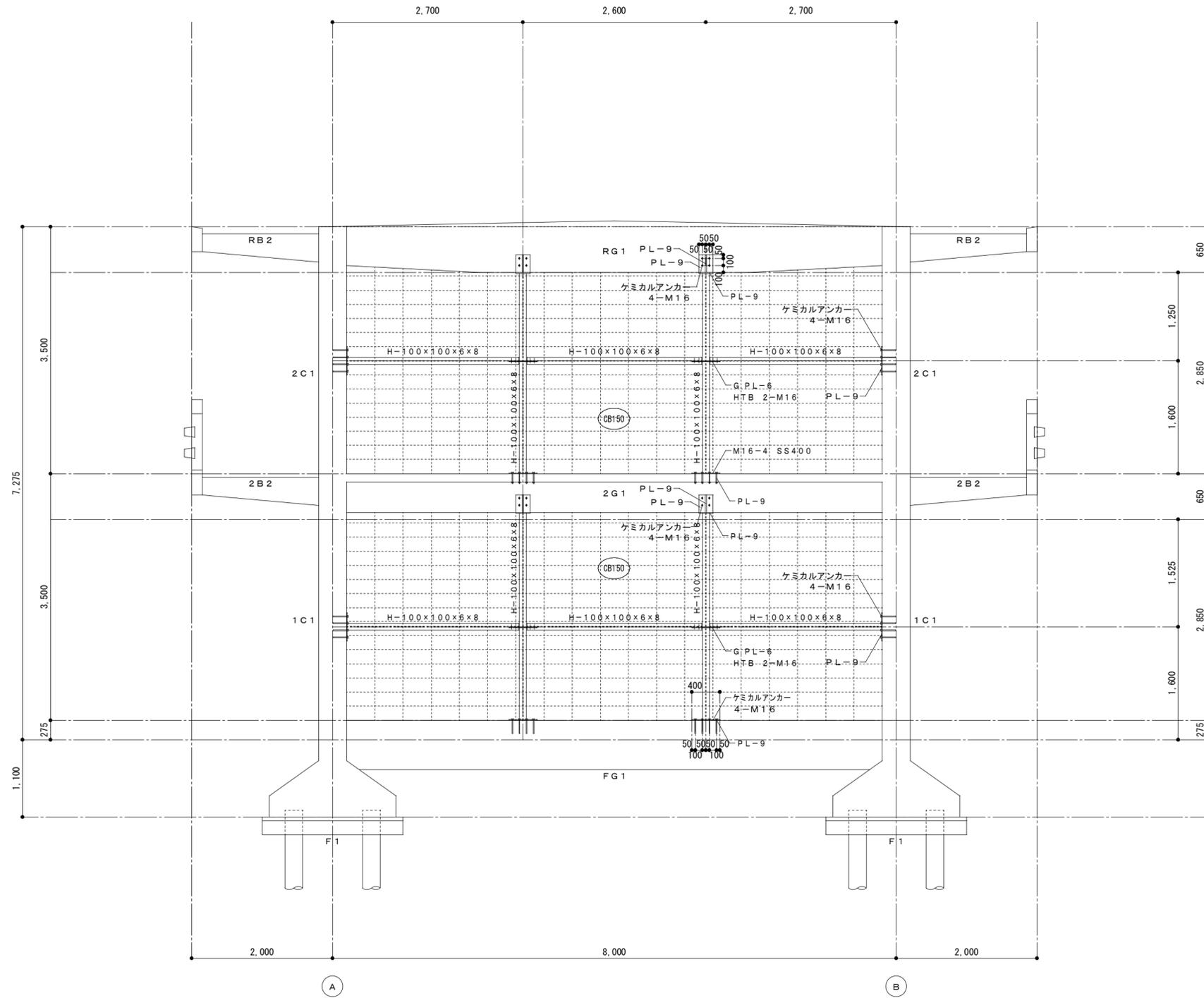
C B 造壁補強詳細図 S=1:50
