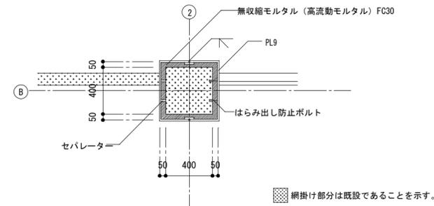
補強柱詳細伏図 S=1:30
