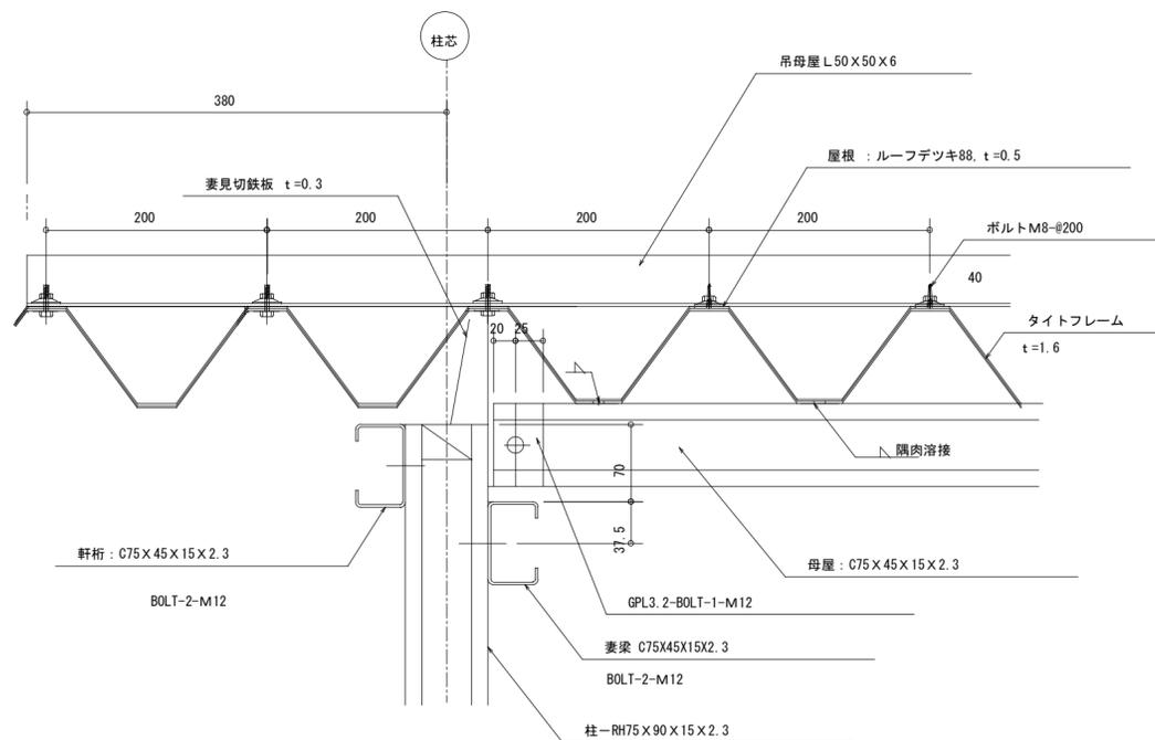
屋根材取り付け詳細図 S=1:5
