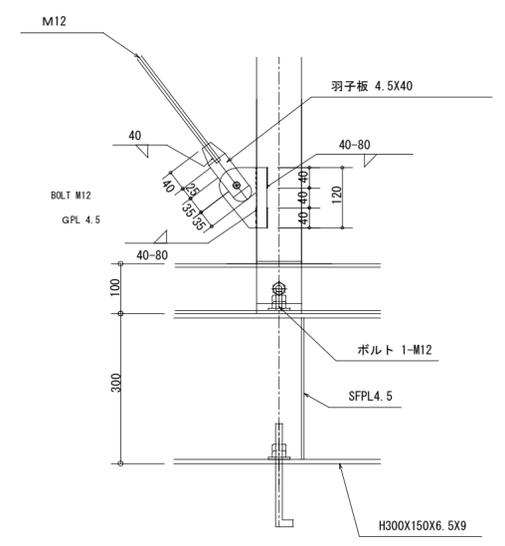
桁妻側土台詳細図-S = 1 : 10
