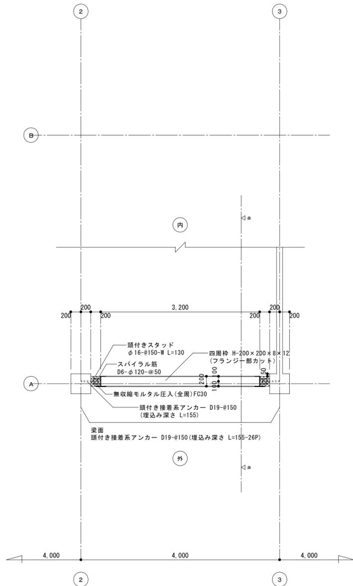
鉄骨ブレース伏詳細図 S=1:50
