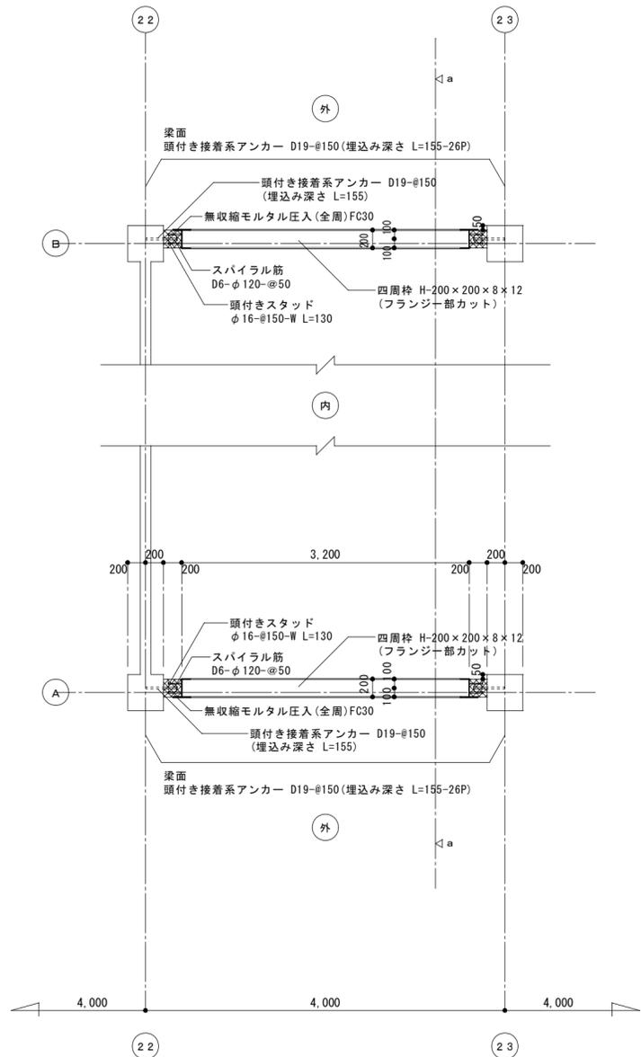
鉄骨ブレース伏詳細図 S=1:50
