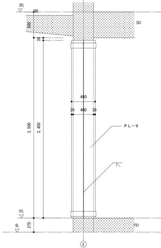
補強柱断面詳細図 S=1:30
