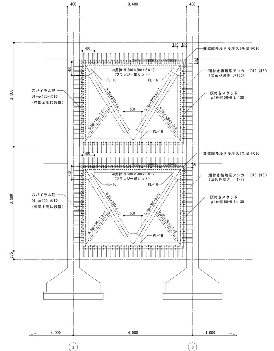
鉄骨ブレース断面詳細図 S=1:50
