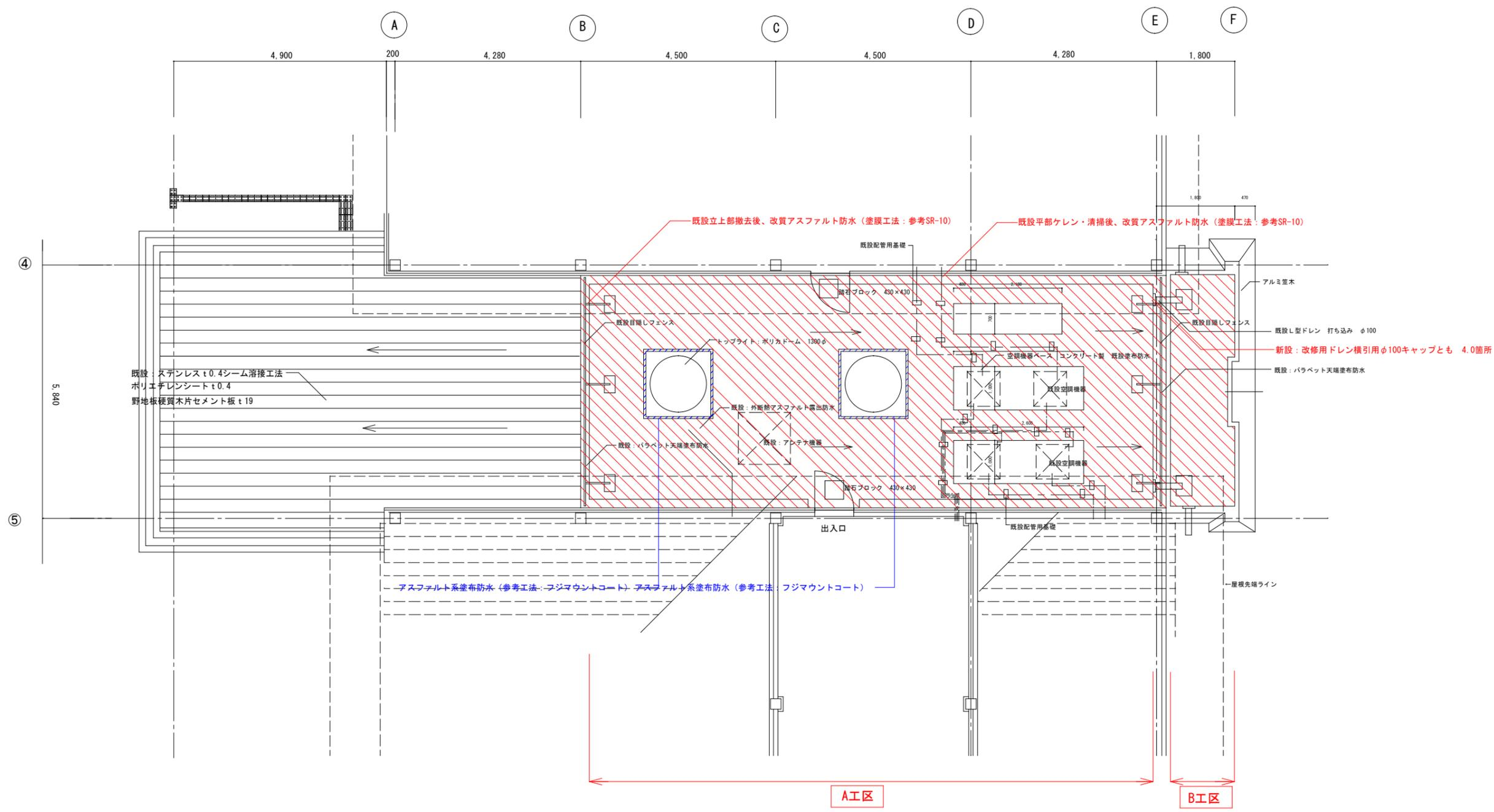
※踏石ブロック、アンテナ及び配管用基礎は、施工に支障がないように一時取外し、施工後に再度据え付けること。
