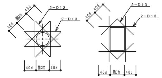
開口補強筋詳細図
