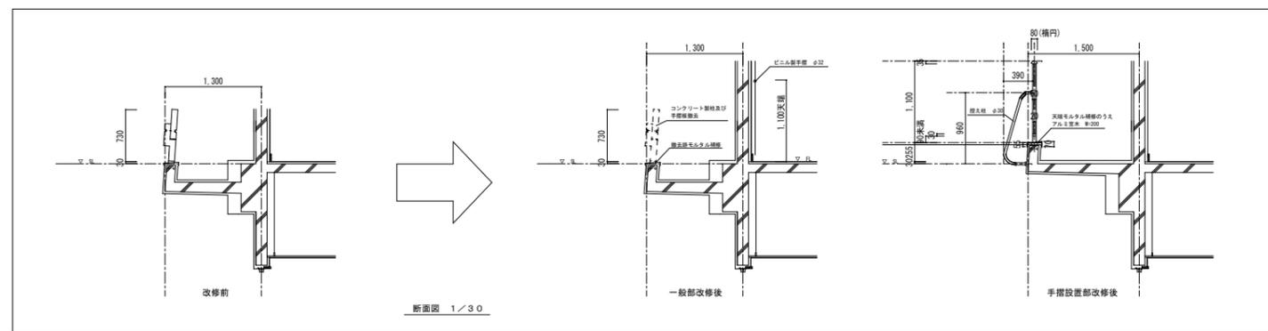
既存手摺部撤去及び室内側手摺新設
