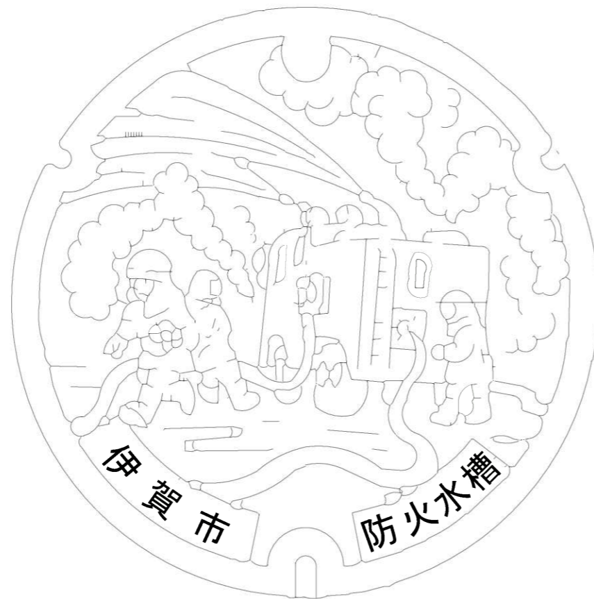
開閉用袋パール穴 蓋平面図
