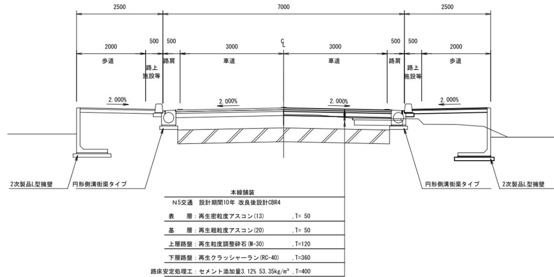
市道舗装工断面図
