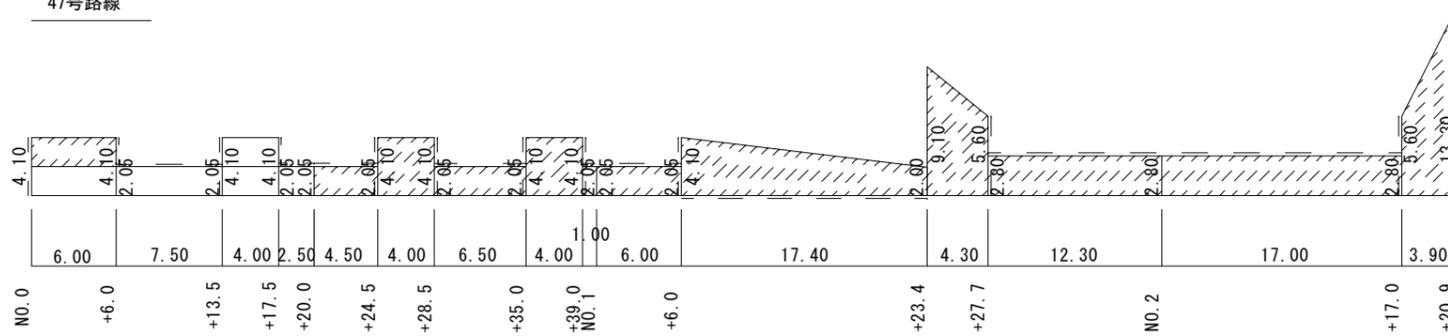
舗装切断  $\phi 50$ 以下路線 L=78.15m
