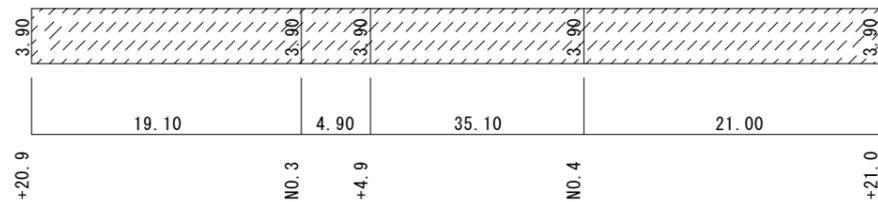
舗装切断  $\phi 50$ 以下路線 L=3.90m
