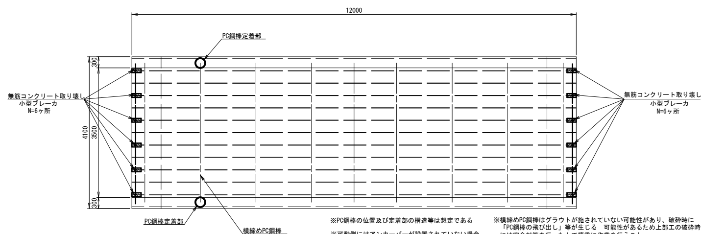
主桁部 切断・取壊し平面図
