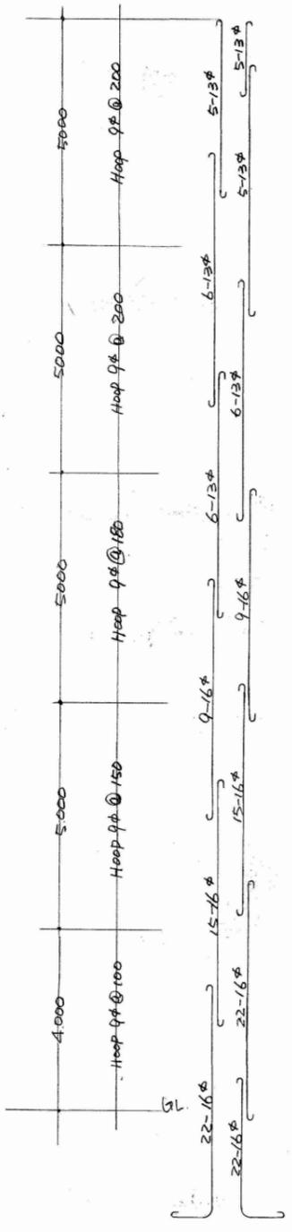
主筋継手指示図 1/100
