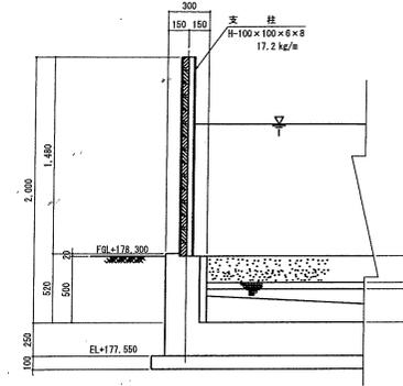
A部堰板受枠部詳細図 S=1:5
