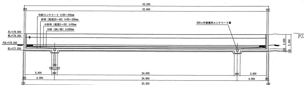
汚泥搬出口部断面図 S=1:50
