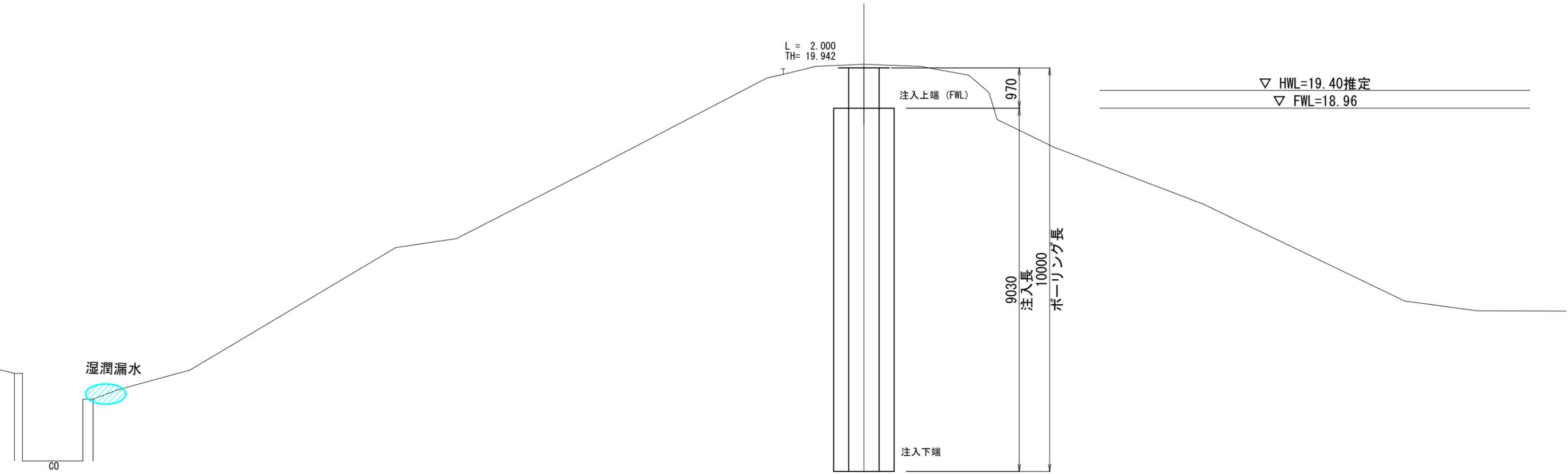
※注入材については懸濁型無機中結(岩水3号(10%液))+早強セメントによるものとする
