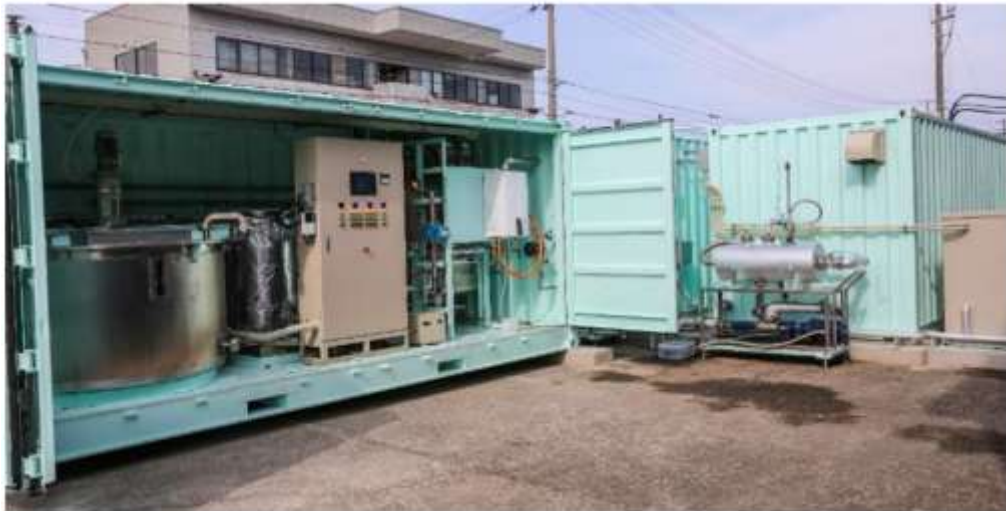
図70 超小型バイオガスプラント (出典：NTT 東日本グループ 株式会社バイオストック)
